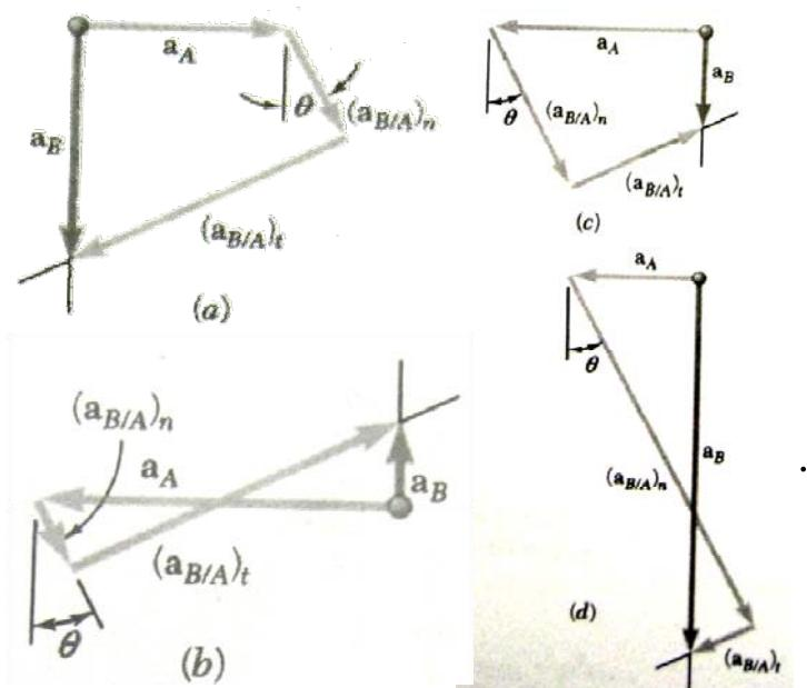
باید توجه داشت که قبل از حل مسئله تنها می‌توانیم راستای شتاب مطلق B و شتاب مماسی B نسبت به A را تعیین کنیم، بنابراین چهار حالت نشان داده شده در شکل می‌توانند رخ دهند، که در اینجا به بیان روابط هندسی بین بردارها در حالت a اکتفا می‌کنیم.
