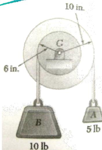
قرقره ای به وزن 12lb و شعاع ژیراسیون 8in به دو وزنه مطابق شکل متصل شده است. با فرض اینکه اصکاک محوری وجود ندارد شتاب زاویه ای قرقره و شتاب هر یک از وزنه ها را تعیین کنید.
