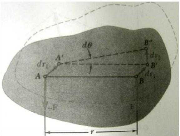
کار ناشی از چرخش + کار ناشی از جابجایی : کار کلی
